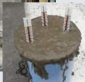
Sitio de construcción (Revisando contenido de cloruro en hormigón fresco)
